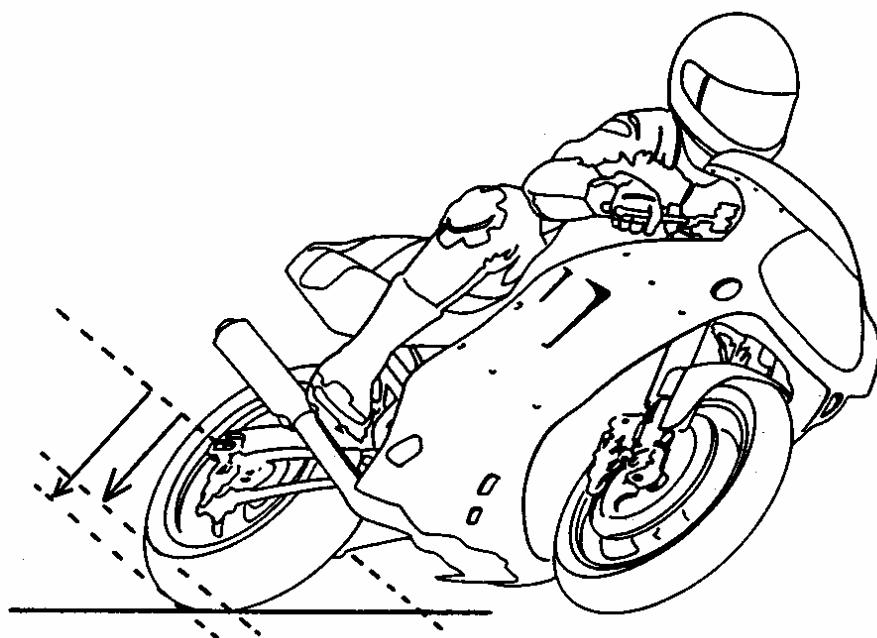
Диаметр колеса изменяется с наклоном байка, что влияет на обороты двигателя в повороте.
